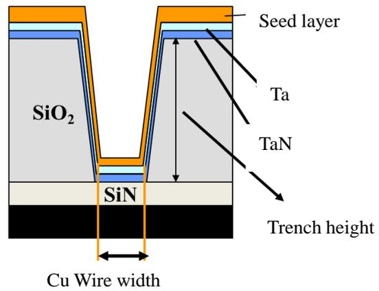
図 6 - 1 2 Cu配線構造
